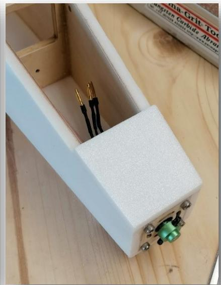
Les colonnettes d'espacement du moteur en impression 3D permettent de loger le moteur à l'intérieur du fuselage.
